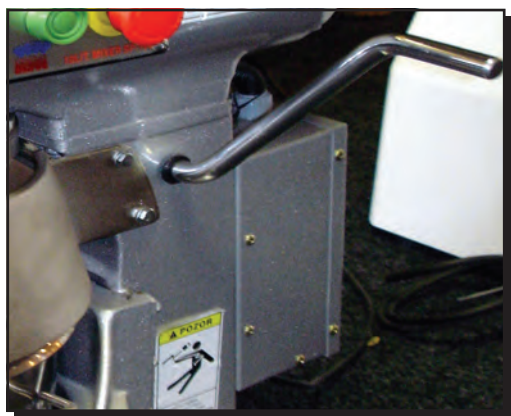
Mikrospínač pracovní polohy kotlíku
