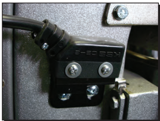
Mikrospínač pracovní polohy kotlíku
